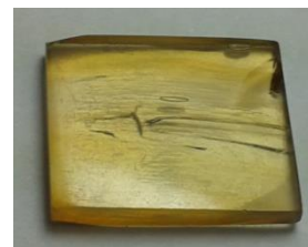
Figura 3 – Vidro de Borossilicato com 62% de CCA.
