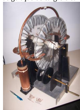
Figura 2 – Vista total da máquina de Wimshurst dupla construída na FATECSP.
