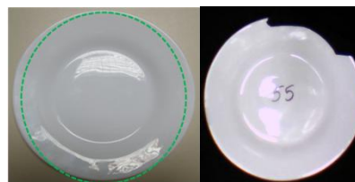
Figura 3 – Exemplos do defeito Deformação.
