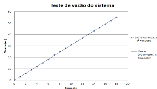
Figura 3- Variação do volume do gás injetado no tempo na câmara de vácuo.
