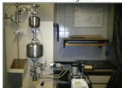
Figura 2- Sistema de vácuo para a determinação de condutância, velocidade de bombeamento e fluxo de gases de misturas gasosas.
