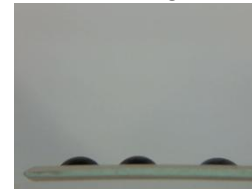
Figura 2(b): Gotículas de PEDOT:PSS sobre ITO da Diamond Coatings.
