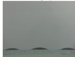
Figura 2(a): Gotículas de PEDOT:PSS sobre ITO da Displaytech.
