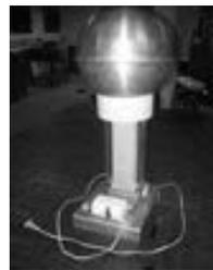
**Figura 2** – Vista geral do aparelho eletrostático de Van der Graaff
