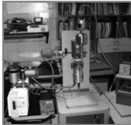
Figura 1. Arranjo experimental para a medição de grandezas para o cálculo de condutâncias.
