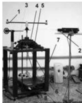
Figura 1 – Sistema: (1)- Pêndulo, (2)- Sensor de força ( $SF$ ), (3)- Sensor de rotação ( $SMR$ ), (4)- Amostra de poliuretano, (5)- Estrutura, (6)- Sistema rotacional ( $SR$ ), (7)- Interface 750 da PASCO, (8)- Fixação da amostra.
