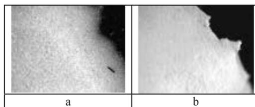
Figura 2 – Microscopia óptica de (a) amido ou (b) dispersão PAN/amido 1:1 após *dip* em água
