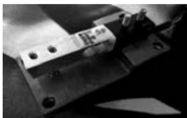
Figura 2 - Célula de Carga Fixada sobre a Base.
