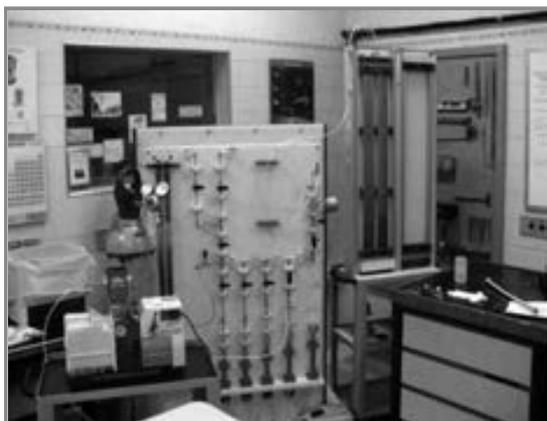
Figura 1. Sistema de padrão de vazamentos e injeção controlada de gases.
