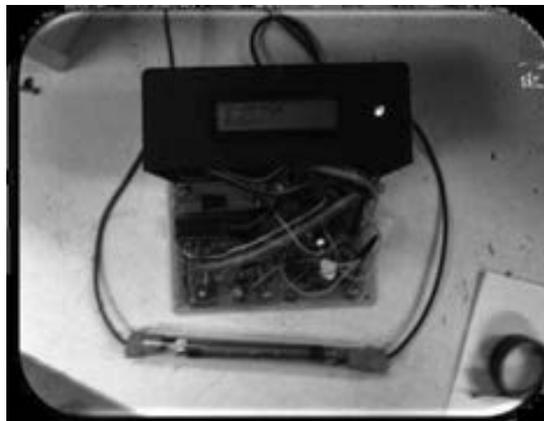
Figura 1: Protótipo do detector Geiger-Müller.
