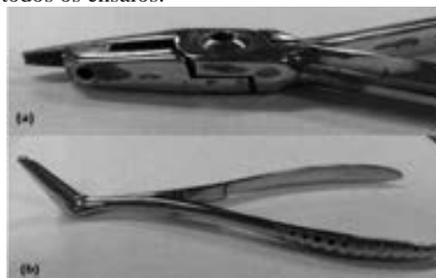
Figura 1 – (a) instrumental com fosqueamento na superfície; (b) instrumental intacto.
