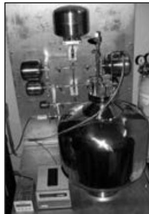
Figura 1 – Sistema de vácuo utilizando o método de expansão estática
