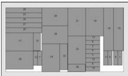
Figura 1 – Resultado da otimização pelo AG+ACO com a codificação por agrupamento.
