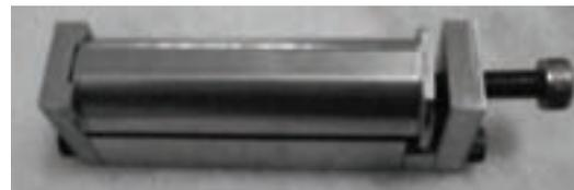
Figura 2 – Base prismática com corpo de prova fixado
