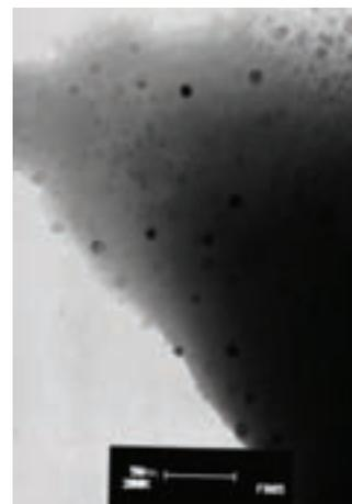
Figura 2 – Micrografia da amostra preparada com , 0,5 % de  $Er_2O_3$ , 0,25% de  $Tm_2O_3$  e 3,0% de  $Yb_2O_3$  e  $AgNO_3$  tratada por 24h.
