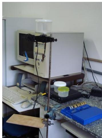
Figura 1 – Recipiente cilíndrico contendo vaselina, Sensor de rotação, Interface, Computador e software da Pasco.
