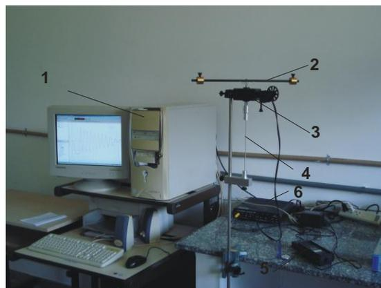
Figura 1 – Computador (1); Pêndulo de Torção (2); Sensor de movimento de rotação (3); Amostra de alumínio (4); Sensor de força (5); Interface (6).
