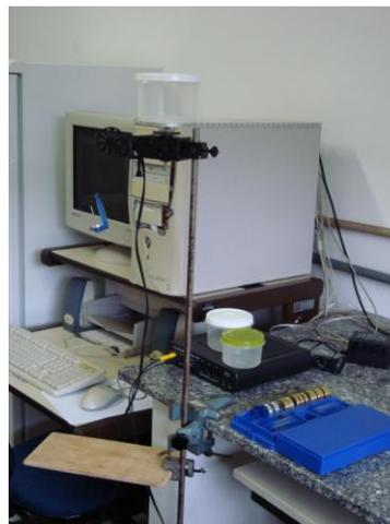
Figura 1 – Recipiente cilíndrico contendo água, Sensor de rotação, Interface, Computador e software da Pasco.
