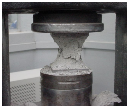
Figura 5 – Determinação da resistência à compressão simples – NBR 13279 [13].
