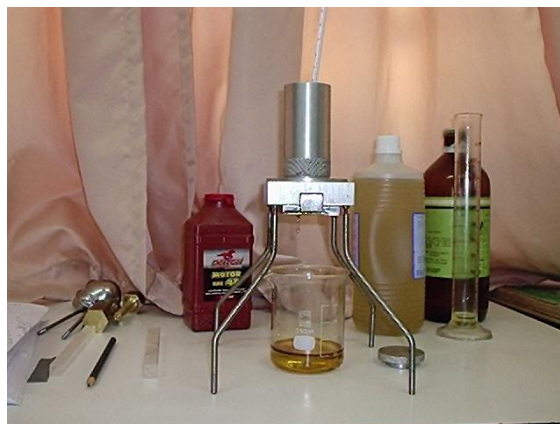
Figura 4. Vista geral da montagem experimental dos testes de calibração do viscosímetro. O béquer na parte inferior serve para coletar o óleo escoado e o termômetro é simplesmente mergulhado no fluido sem necessidade de haste de fixação
