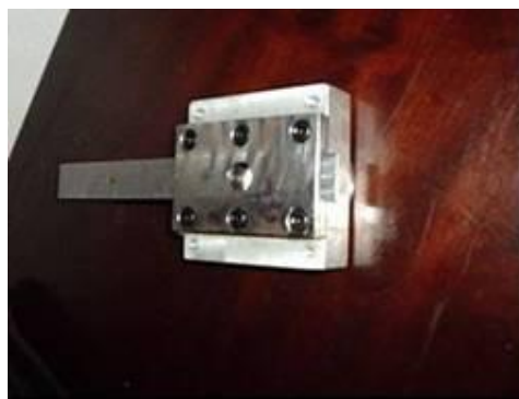
Figura 2. Vista da parte inferior da base do viscosímetro sem o copo, para mostrar a lâmina guia para a centralização dos furos de liberação do fluido.
