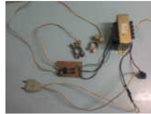
Figura1- Montagem do carregador de bateria
