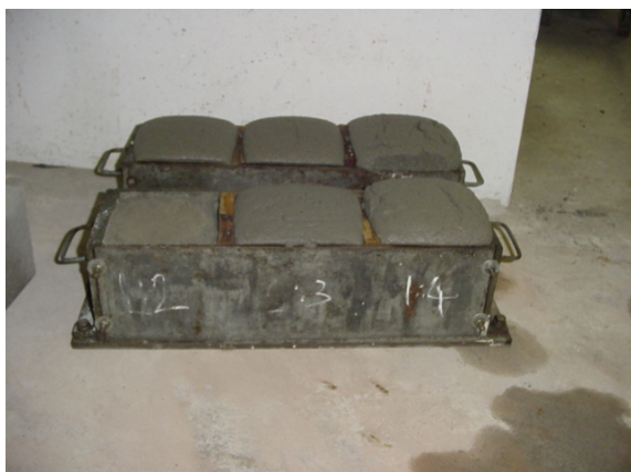
Foto 2 - Concreto celular fresco em expansão na forma cúbica.
