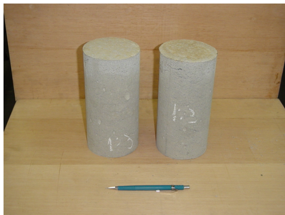
Foto 4 – Corpo-de-prova de concreto celular endurecido.
