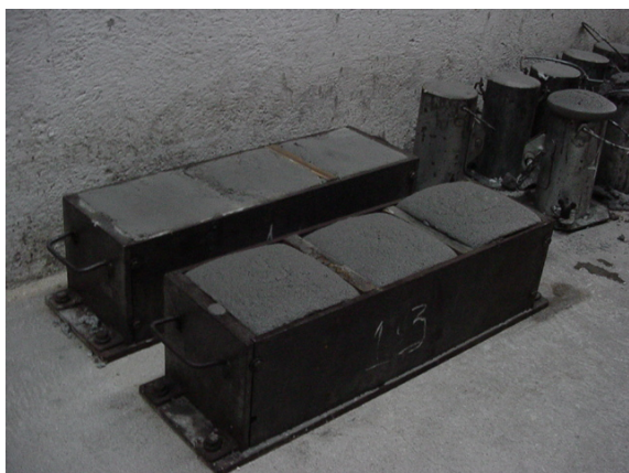
Foto 3 - Concreto celular fresco em expansão no primeiro plano e com a superfície acabada no segundo plano.
