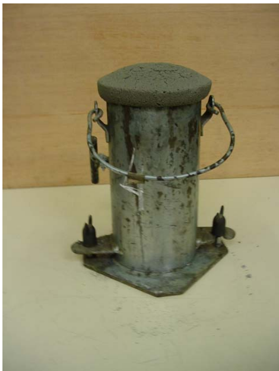
Foto 1 – Concreto celular fresco em expansão na forma cilíndrica.
