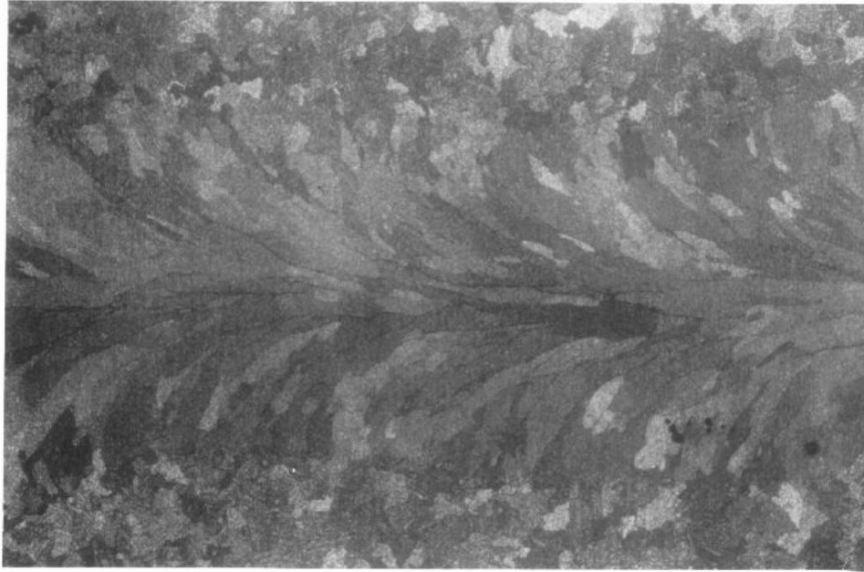
Figura 12 - Macrografia de um cordão de solda de formato gota visto pela superfície. Aumento 10 X
