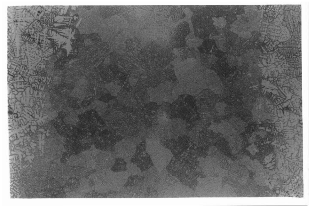
Figura 9 - Microestrutura de um cordão de solda de formato elíptico visto da superfície. Aumento 32 X.
