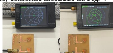
Figura 4 - resposta dentro dos parâmetros em 1,5 GHz e fora de operação na faixa ISM de 2,45 GHz.
