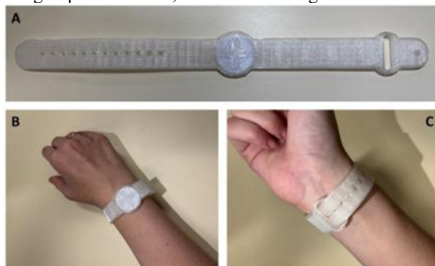
Figura 1: Design da pulseira NFC: (A) Sobre superfície plana; (B) Ajustada ao pulso; (C) Mecanismo de fecho.
