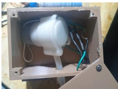
Figura 1 – Parte interna do case, com a bomba Peristáltica e o transistor(BD139) para comutá-la.
