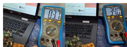
Figura 3 - Colheita de RF, saída de 34mV com excitação a -4dBm
