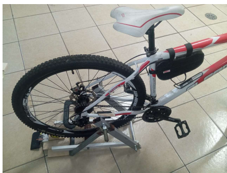
Figura 1 – Protótipo montado na roda traseira da bicicleta
