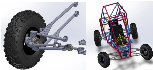
Figura 4 – Montagem do sistema de esterçamento passivo.
