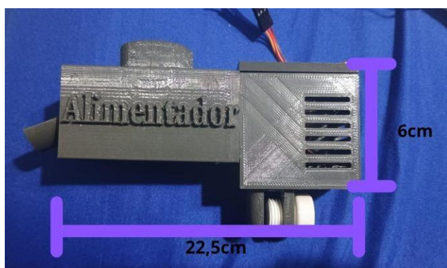
Figura 1 – Imagem do alimentador com suas medidas. Fonte: autoria própria
