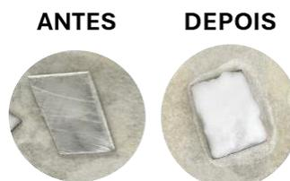
Figura 3 – Substrato antes e depois do recobrimento.
