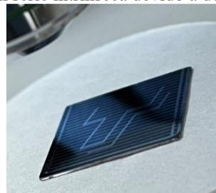
Figura 2 – Célula solar fotovoltaica fabricada, a geometria dos contatos é o “T”.
