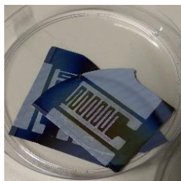
Figura 1 – Lâmina de silício oxidada com estrutura interdigital feita em Al e deposição de filme de SnO 2 .
