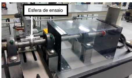
Figura 2 – Equipamento “ball-cratering” utilizado.
