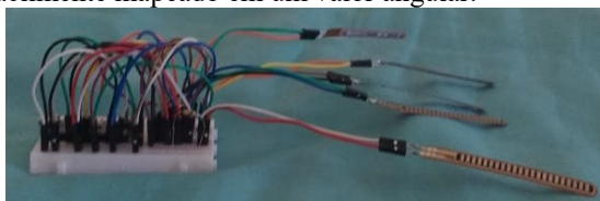
Figura 1: Montagem dos Sensores flexíveis para coleta de dados.
