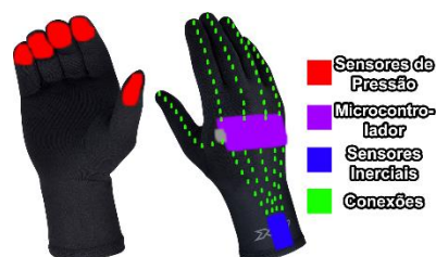
Figura 2 – Disposição dos componentes na luva e conexões.
