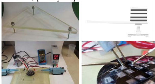
Figura 19. Arranjo experimental para medição da ddp dos microsensors na ponte de Wheatstone.
