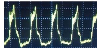
Figura 3 – Forma de onda demonstrada na 99ª célula da linha a 63,3kHz.
