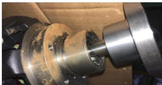
Figura 2 – Conjunto de conexão do motor elétrico.
