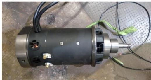
Figura 1 – Motor Schabmüller de 2300 RPM.
