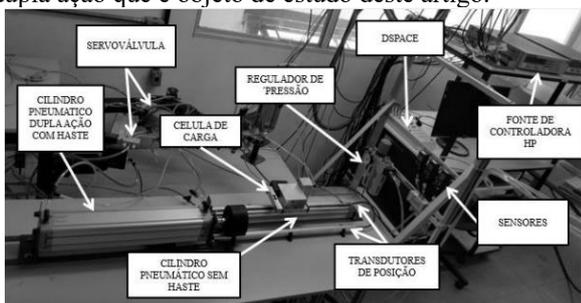
Figura 1 – Descrição dos componentes da bancada Servo pneumática.
