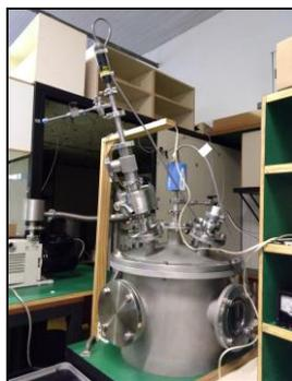
Figura 2. Câmara com ambiente controlado.
