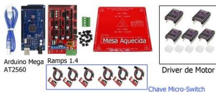
Figura 2 – Principais Componentes Eletrônicos
