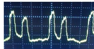
Figura 2 – Forma de onda demonstrada na 99ª célula da linha a 25kHz.
