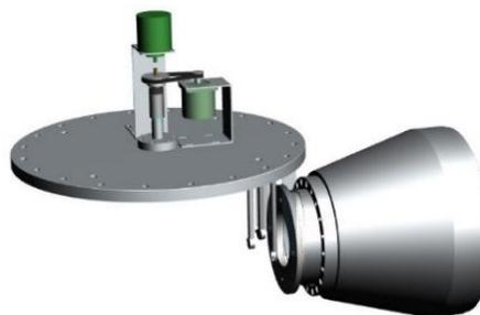
Figura 1 - Sistema de movimentação acoplado à câmara de vácuo
