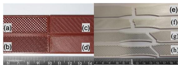
Figura 2: Preenchimento dos corpos de prova em PLA. (a) 25%; (b) 50%; (c)75%; (d) 100%, fratura do corpo de prova de tração (e) ABS 25%; (f) ABS 50%; (g) ABS 75%; (h) ABS 100%
