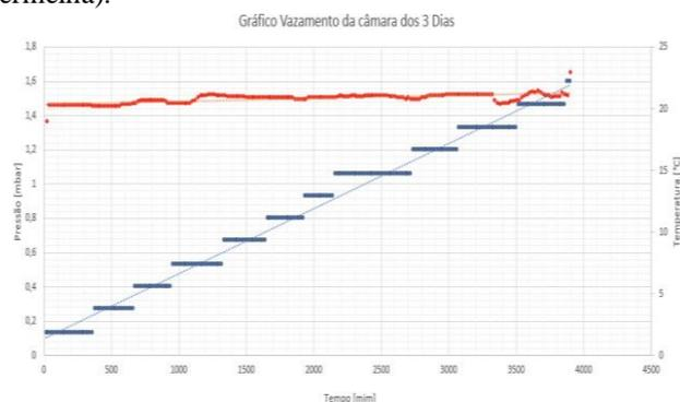
Figura 2 Variação da pressão na câmara de vácuo em função do tempo (curva azul) e variação da temperatura em função do tempo (curva vermelha).
