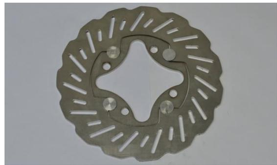
Figura 2 – Disco após o corte a laser.
