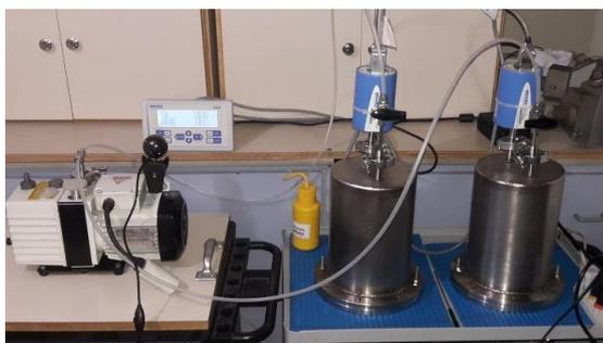
Figure 1. Câmaras de vácuo com medidores de pressão para a determinação experimental da taxa de vazamento.
