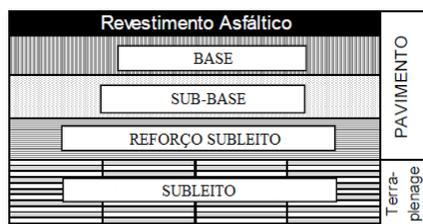
Figura 1: Camadas de um pavimento
