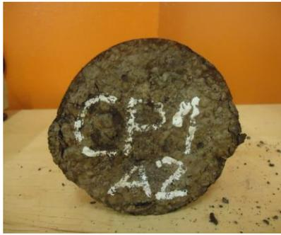
Figura 9: Corpo de prova ensaiado - Marshall
