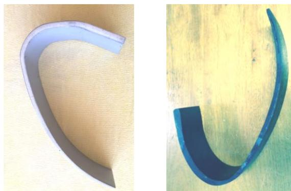
Figura 08 – Formato “C” em fibra de carbono
