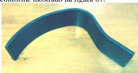
Figura 07 – Prótese formato “J” com dimensões finais
