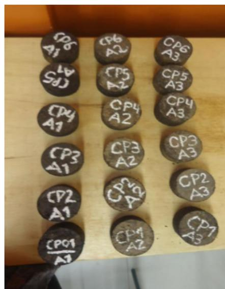
Figura 8: Corpos de prova – Marshall
