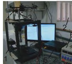
Figura 1A—Arranjo experimental: (1) SMR; (2) Quatro amostras de Teflon; (3) Pêndulo de Torção; (4) Eletroímã; (5) Interface PASCO 750; (6) Fonte DC.
