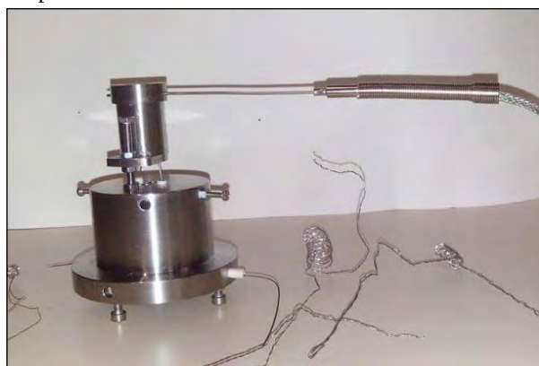
Figura 2 – Forno elétrico montado com o termopar.
