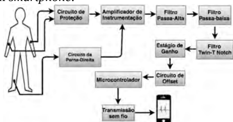
Figura 1 – Diagrama de blocos do processo de aquisição e visualização dos sinais de ECG.
