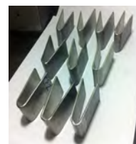
Figura 5: Corpos de prova de dobramento sem falhas.
