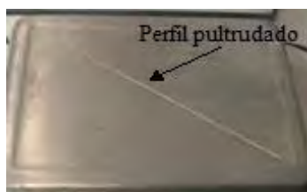
Figura 1 – Amostra de 150 mm do perfil pultrudado obtido.
