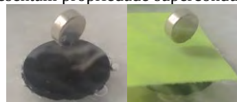
Figura 3 – Teste de levitação magnética baseado no efeito Meissner.
