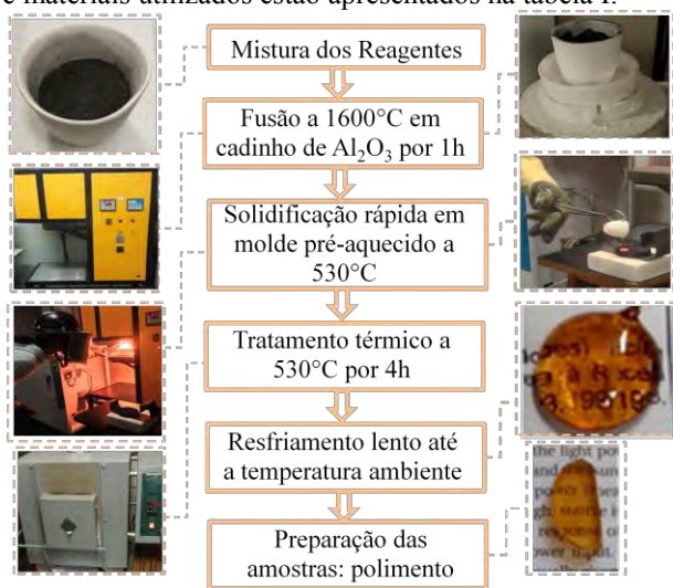
Figura 1- Fluxograma do procedimento experimental realizado para a produção das amostras vítreas.
