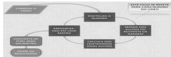
Figura 2. Fluxograma do processamento computacional das imagens digitais [2].
