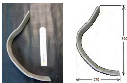
Figura 03 – Modelo construído em fibra de vidro
