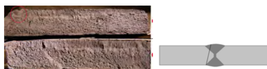
Figura 5: Superfície de fratura corpo de prova sem pré-aquecimento.
