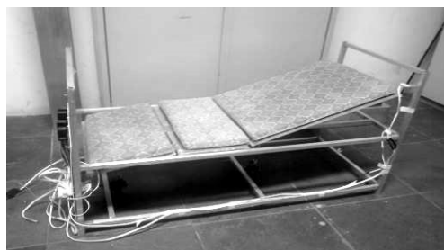
Figura 11 – Maquete da cama hospitalar utilizada para teste
