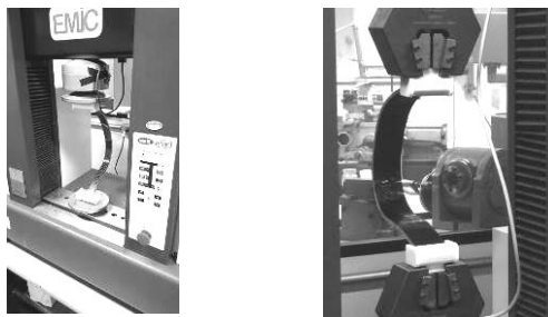
Figura 5 – Teste de compressão
