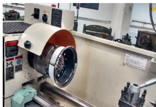
Figura 7 – Roda montada no torno mecânico. (Fonte: Autores)
