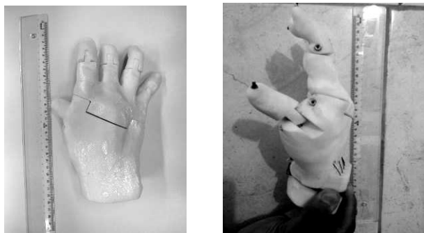
Figura 8 – Prótese de mão obtida em impressora 3D, confeccionada em plástico ABS
