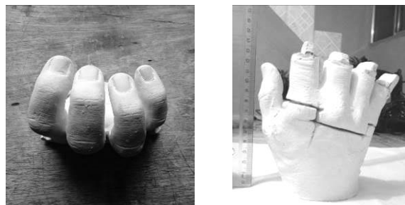
Figura 6 – Modelo em gesso utilizado para gerar arquivos Parasolid.
