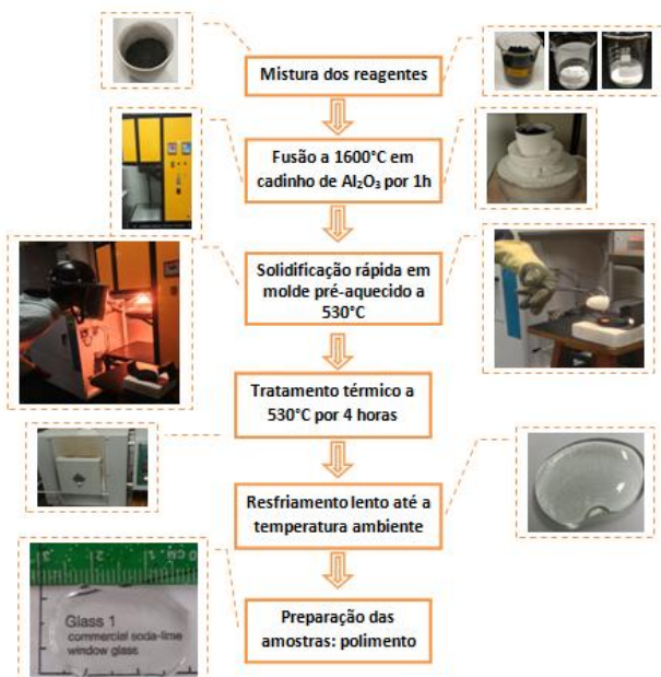
Figura 1- Fluxograma do procedimento experimental realizado para a produção das amostras vítreas.
