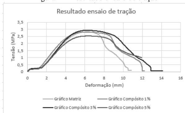
Figura 1 – Resultado ensaio de tração
