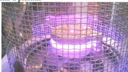
Figura 1- Descarga de um reator planar a plasma com 450 V e 30 mA.
