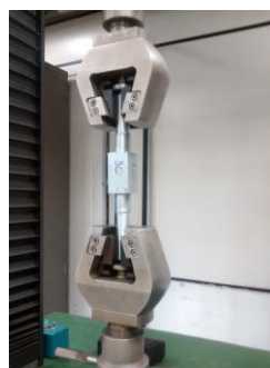
Figura 2 – Corpo de prova posicionado na máquina.
