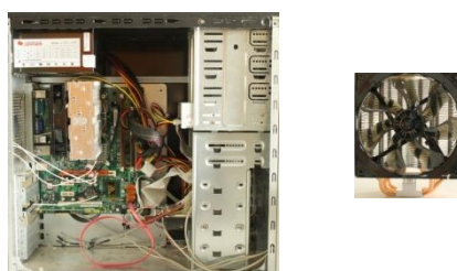
Figura 3 – Testes com dissipador aletado com tubos de calor.
