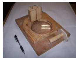
Figura 2- Bipartição do molde facilita a extração do modelamento.
