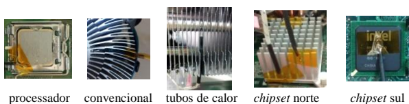
Figura 4 – Posicionamento dos termopares tipo K.
