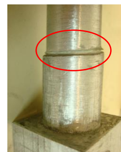
Figura 3 – Ruptura à tração.
