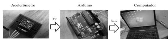
Figura 1 – Estrutura do mecanismo para obtenção e tratamento de dados do sensor.
