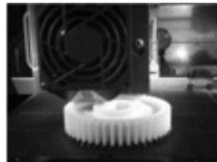
Figura 3 – Construção pelo método de deposição.
