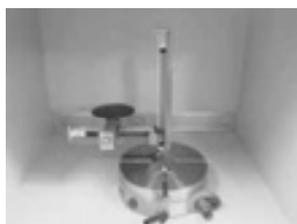
Fig. 1 – Estágio de movimentação da amostra.
