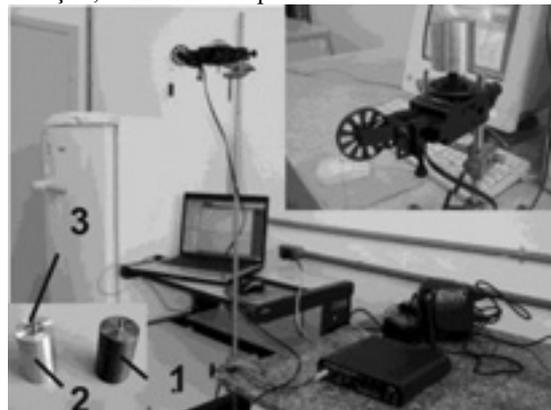
Figura 1 – Sistema de medida: Cilindros, Sensor de rotação, Interface, Computador e software específico.
